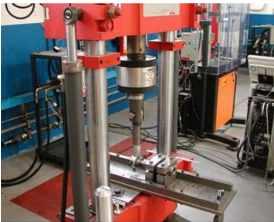
Figura 7: Attrezzatura per le prove di fatica.
