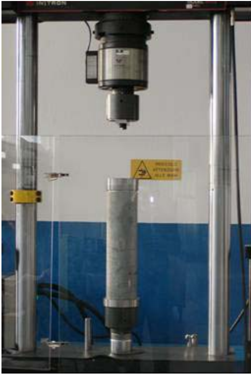
Figura 6: Attrezzatura utilizzata per i piantaggi.
