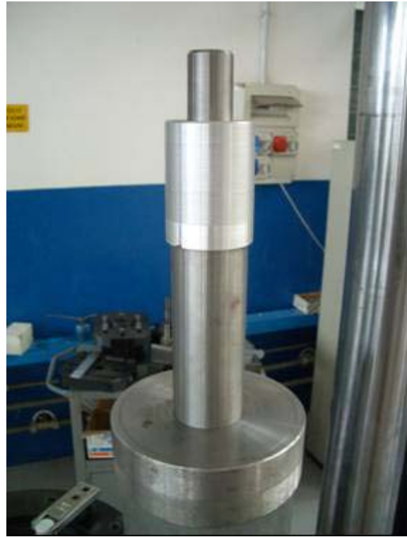
Figura 6: Attrezzatura utilizzata per i piantaggi.
