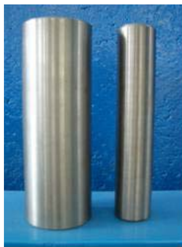
Figura 2: Boccia equivalente e perno disaccoppiati.
