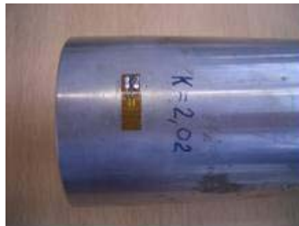
Figura 5: Estensimetro incollato sul diametro esterno di una boccola.
