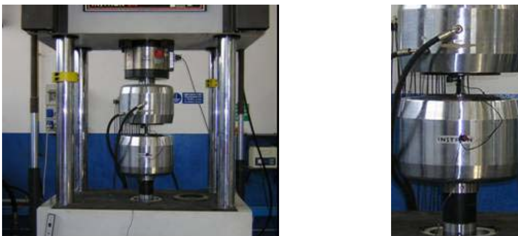
Figura 3: Pressa idraulica Instron da 50 kN utilizzata per le prove di trazione.
