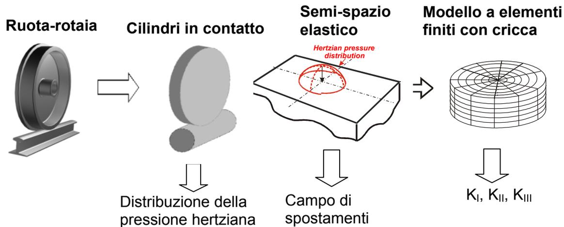
**Figura 1:** Schema risolutivo dell'approccio ibrido sviluppato per contatti di tipo hertziano.
