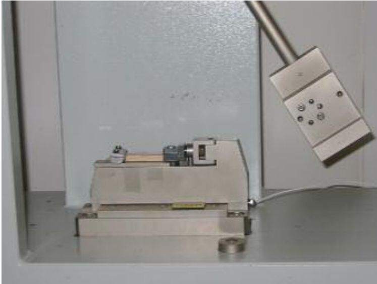
Fig.1: Il pendolo strumentato CEAST utilizzato nella configurazione di impatto tensile.
