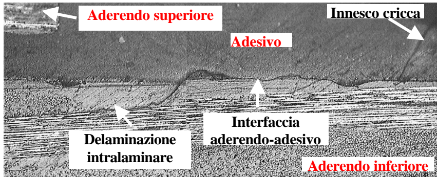
Figura 6. Danneggiamento a fatica della giunzione, sovrapposizione 30 mm, \sigma_{\max}=40\% \sigma_{UTS}
