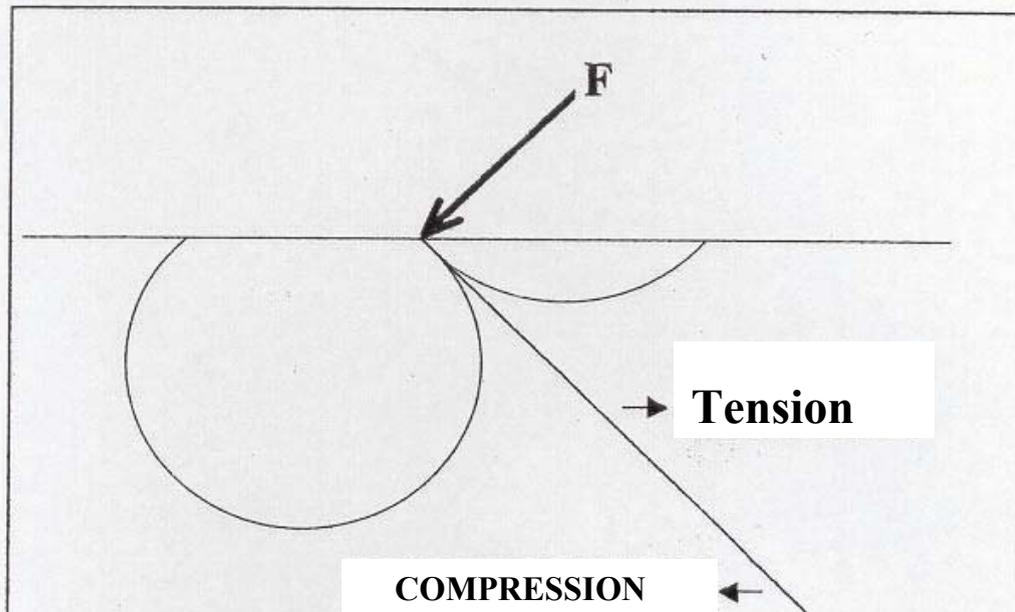
Fig.1.2.3.14. Stato delle tensioni e delle deformazioni per un materiale elastico-perfettamente plastico sollecitato da un carico concentrato  $F$ . Gli archi di cerchio rappresentano i luoghi di tensione tangenziale massima costante.
