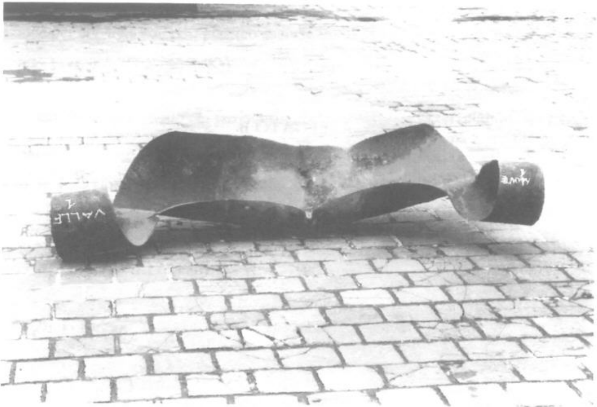
Fig. 1 a - Campione pervenuto: Propagazione di 1700 mm che interessa due tubi a monte: 1140 tubo a monte della saldatura circonferenziale e 560 tubo a valle.
