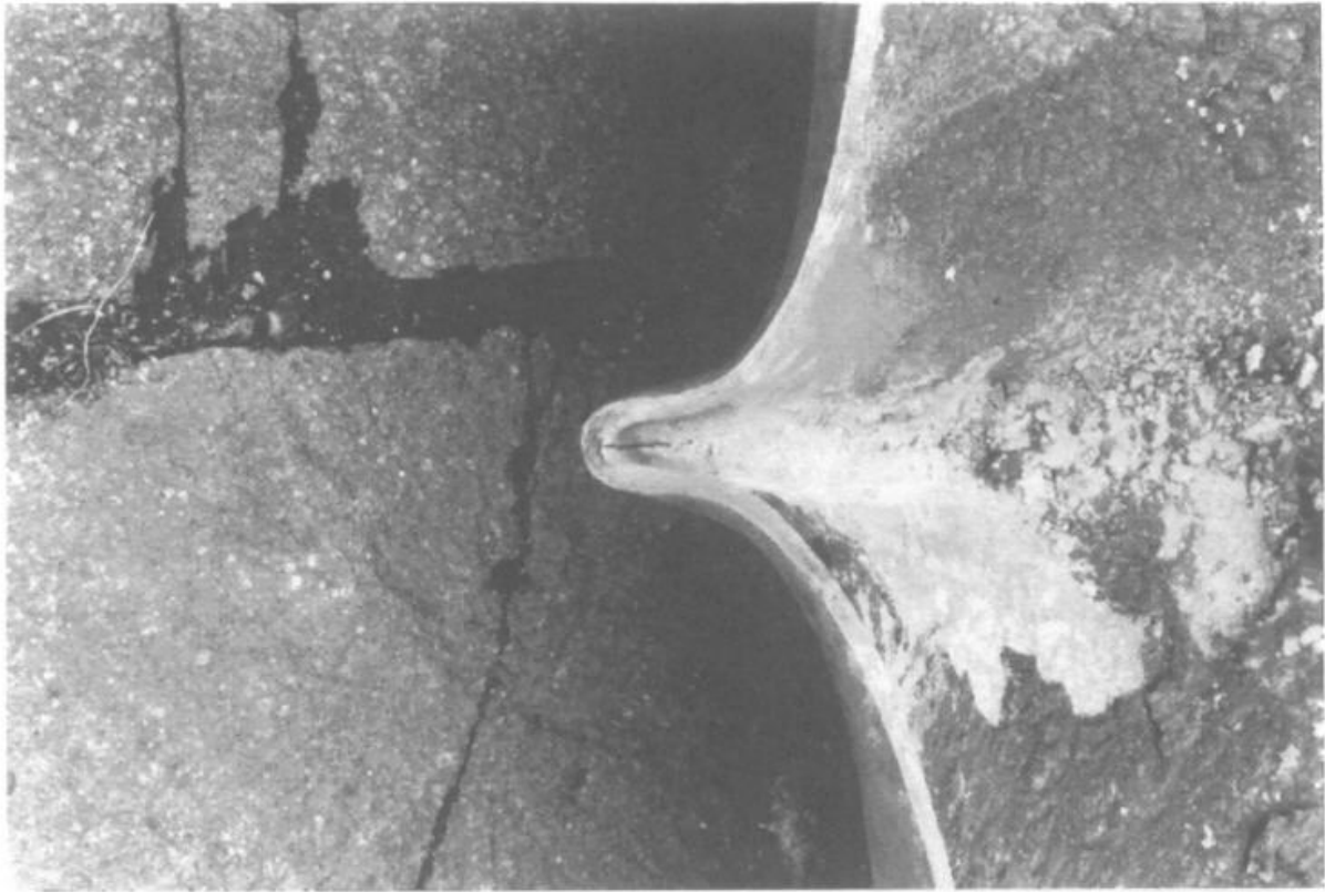
Fig. 2 a - Particolare della grinza interessata da una fessurazione superficiale interna.
