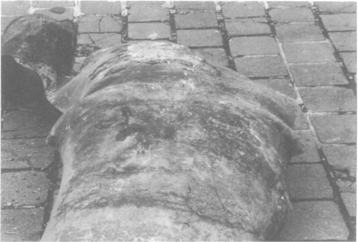
Fig. 3 - Si nota che l'innesco era localizzato a metà della grinza.
