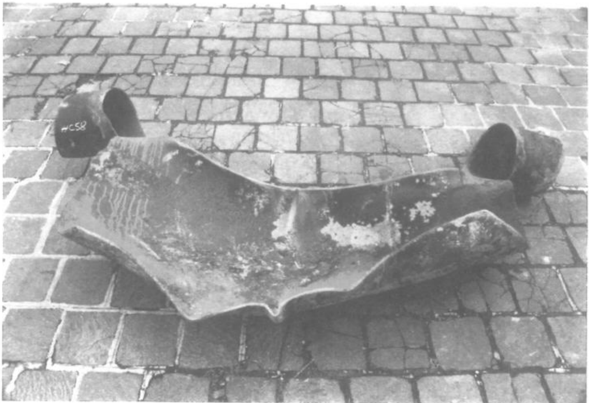
Fig. 1 b - Innesco localizzato sulla grinza distante 375 mm della saldatura circonferenziale di valle.
