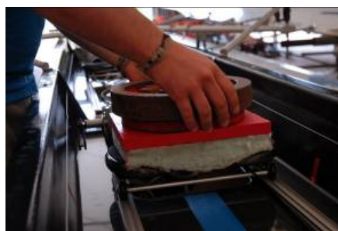
Figura 4: Taratura del sensore di forza del seggiolino.
