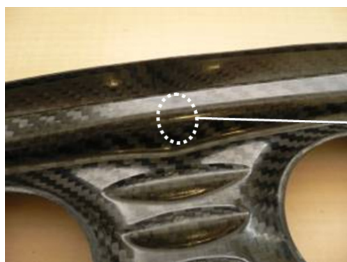
Figura 9: Posizione del difetto superficiale riscontrato.
