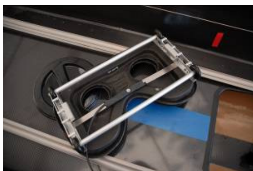
Figura 3: Sensore di forza installato sul lato inferiore del sedile (carrello in alluminio).
