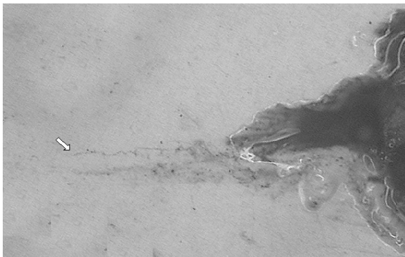
Figura 20: Propagazione della cricca nella direzione ortogonale rispetto alla sollecitazione di fatica.
