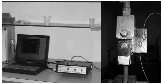
Figura 17: Set-up sperimentale per il sensore FBG.
