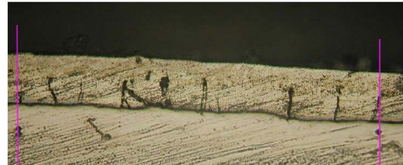
Figura 3: Parte dell'impronta da 3 J (distanza tra i riferimenti 0,5 mm).
