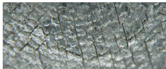
Figura 13: Dettaglio dell'impronta della prova statica da 1,3 mm di spostamento imposto (4.5 J)
