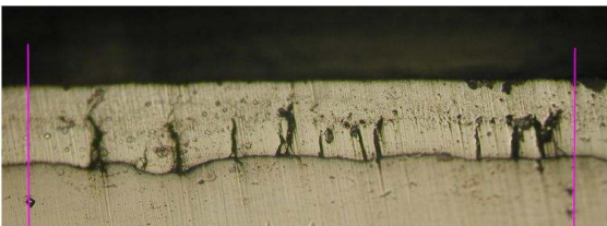
Figura 4: Parte dell'impronta da 4 J (distanza tra i riferimenti 0,5 mm).
