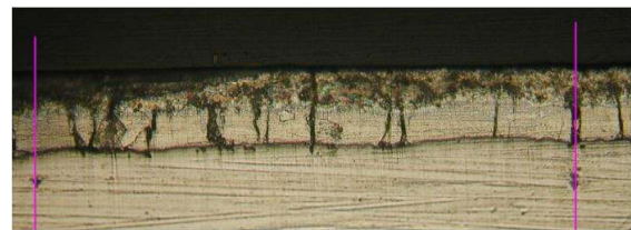
Figura 5: Parte dell'impronta da 5 J (distanza tra i riferimenti 0,5 mm).
