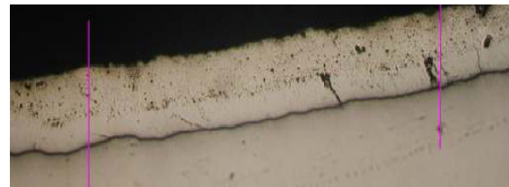
Figura 7: Parte periferica dell'impronta da 6 J (distanza tra i riferimenti 0,5 mm).
