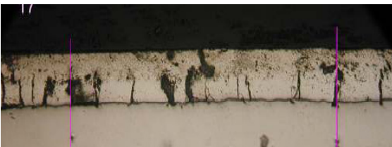
Figura 6: Parte dell'impronta da 6 J (distanza tra i riferimenti 0,5 mm).
