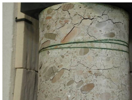
Foto 6: Campione dopo il riscaldamento a 800° C.
