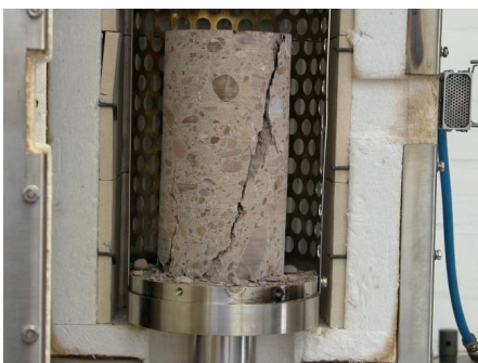
Foto 5: Esempio di rottura del campione.
