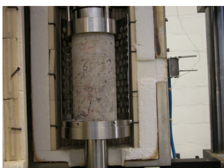
Foto 3 e 4: Esempio di rottura del campione con particolare.
