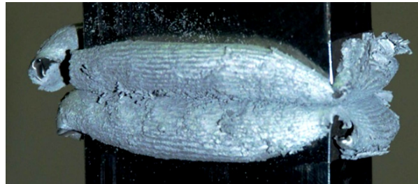
Figura 8: Aspetto del giunto ottenuto per LFW su AMC225.
