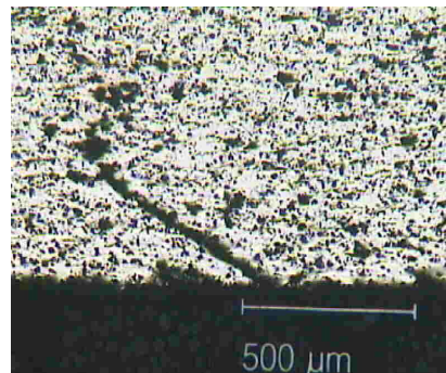
Figura 4: Difetto dovuto alla non completa penetrazione di saldatura sul lato opposto alla spalla dell'utensile nel giunto FSW sul composito W7A10A.
