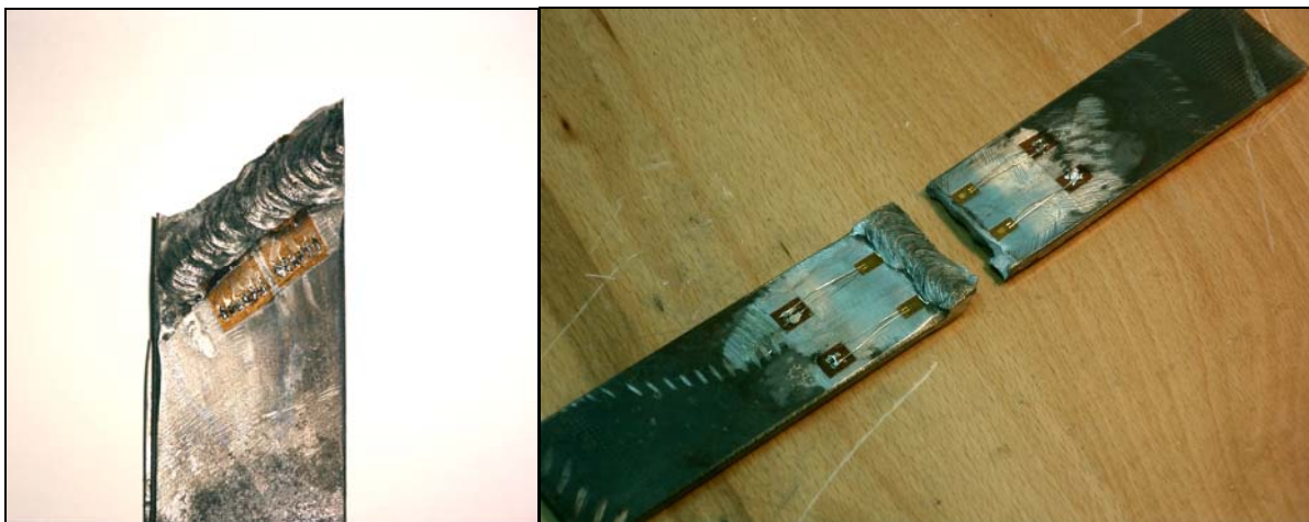
Figura 1: Alcuni esempi dei giunti saldati in acciaio utilizzati per i test di fatica.
