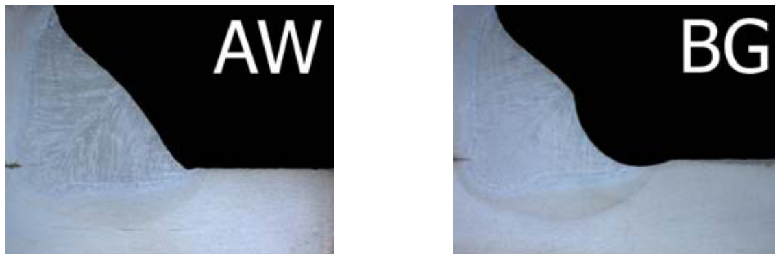
Figura 1: Geometria e microstruttura in un giunto come saldato AW o lavorato al piede con mola BG [22].
