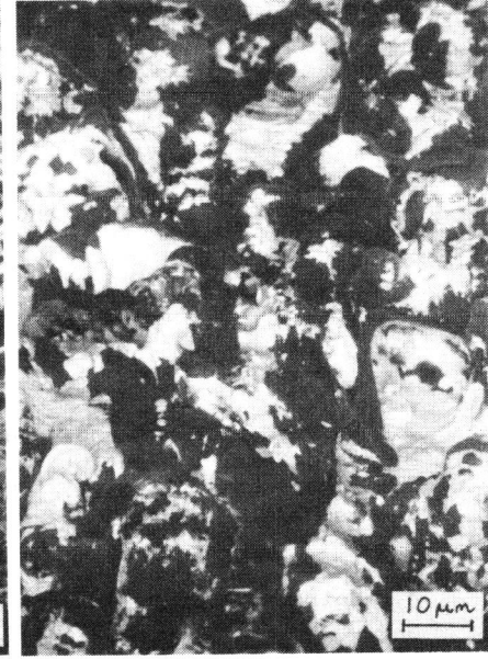
Fig.2b Al18Sn1Cu fracture surface BEI of Testpiece 1.
