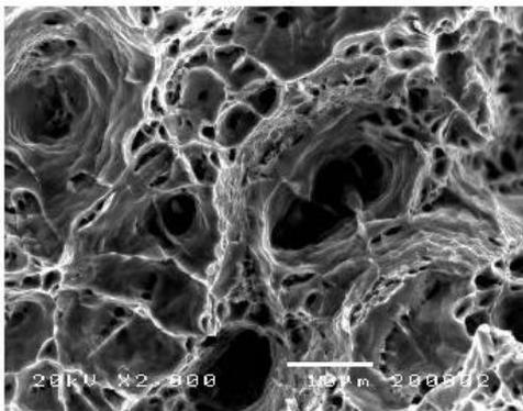
a. Ductile fracture
