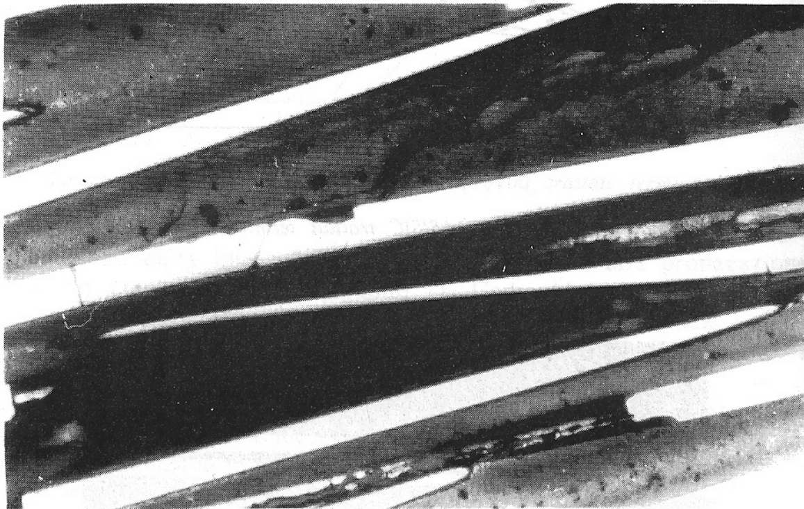
Fig. 6 Propagazione del crack negli strati con fibre parallele alla propagazione stessa
