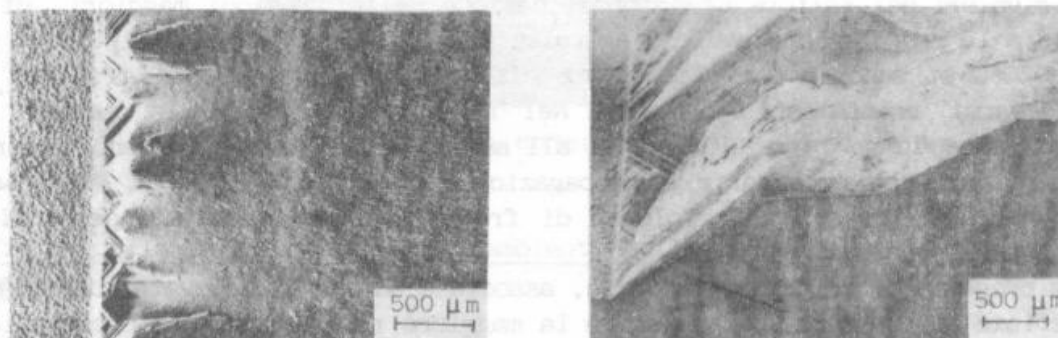
Fig. 2. Superficie di frattura di un campione TMT precriccato di 0,4 mm a 20°C con propagazione a 950°C in aria e forma d'onda triangolare (a) e precriccato di un 1 mm a 20°C con propagazione a 950°C in aria e hold time (b).
