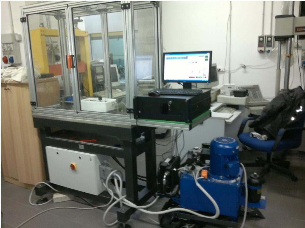
Figura 1: Macchina di fatica a sviluppo orizzontale.
