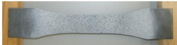
Figura 2: Provino con superficie *speckle*.
