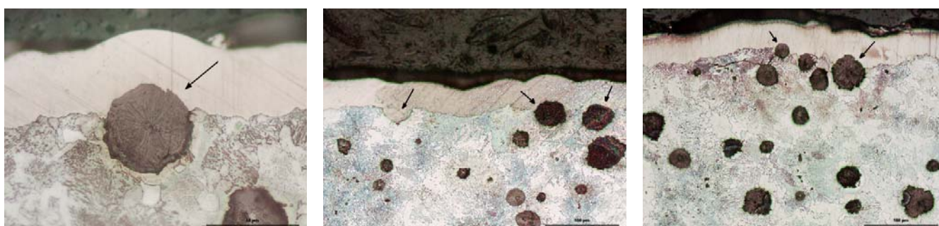
Figura 24: Ghisa sferoidale ferrito-perlitica. Analisi LOM del profilo trasversale (da sinistra verso destra, R = 0.1 , \Delta K = 9, 13, 21 \text{ MPa}\sqrt{\text{m}} , rispettivamente).
