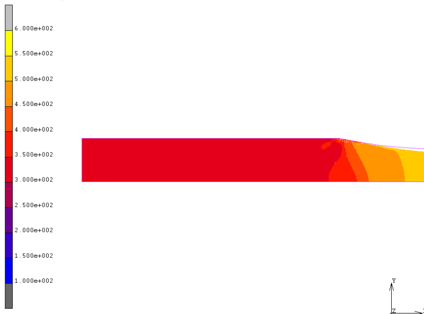
Figura 11: Campo delle tensioni di Von Mises [MPa] prima della rottura.
