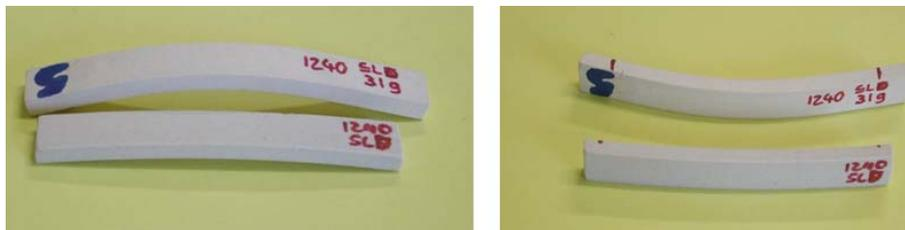
Figura 4: Campioni dopo la prova di inflessione sotto carico a 1240 °C, in basso il campione soggetto al solo peso proprio, in alto il campione soggetto a un ulteriore carico.
