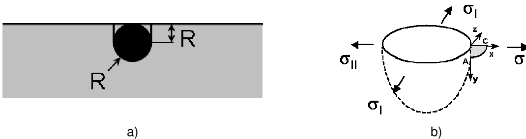
Fig. 5 – Analisi delle soglie di propagazione di difetti rotondi: a) schema geometrico; b) schema degli sforzi principali per una cricca all'apice del difetto.
