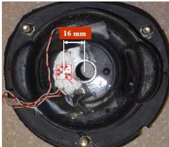
Fig. 6 - Disposizione della rosetta estensimetrica sul Gummilager.
