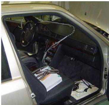
Fig.9 - Veicolo strumentato utilizzato per le prove sperimentali.
