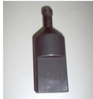
Fig. 5b - Vite di spinta
