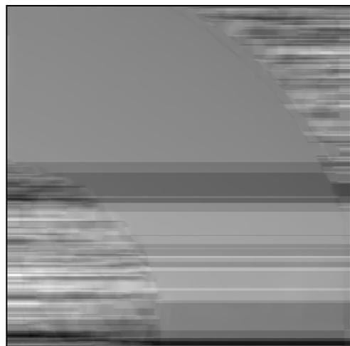
Fig. 11 - Risultato dell'operazione di unwrapping con presenza di discontinuità
