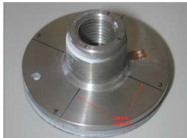
Figura 6 - Indicazione delle quattro zone sulle quali viene eseguita la lettura radiale delle quote
