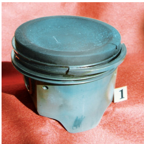
Fig. 4 – L'articolo di prova danneggiato nel corso della prova al banco.
