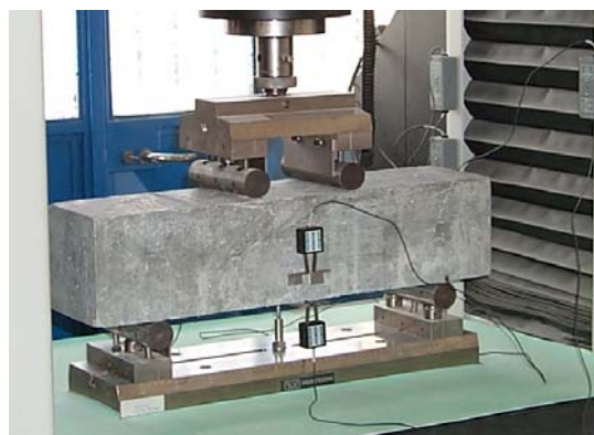
Fig. 3 – Geometria (a) e strumentazione (b) dei provini di trave intagliati secondo UNI 11039.
