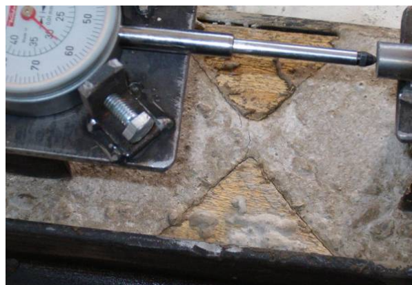
Fig. 4 – Geometria delle piastre (a) e particolare della fessurazione dovuta a ritiro (b).
