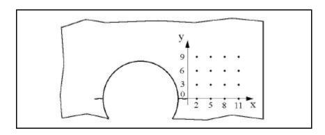
Figura 2 Schema del provino con la posizione dei punti di misura a partire dall'apice della cricca.
