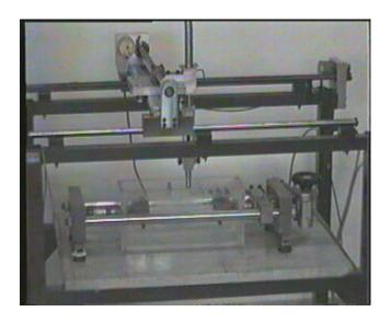
Figura 1 Immagine del robot cartesiano, della vasca e della attrezzatura per caricare il provino.
