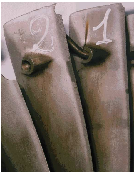
Foto n° 1: erosione da particelle di acqua su pale
