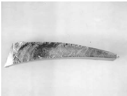
Foto n° 7: frattura transgranulare per fatica su pala n° 2
