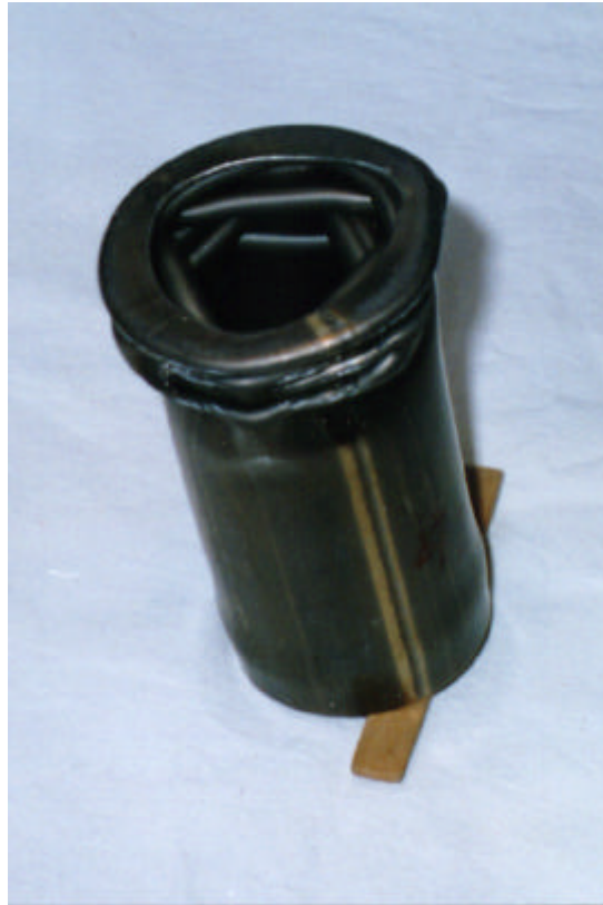
Foto 2: Provino tipo 1: Velocità 10 m/s, Massa 110.7 Kg
