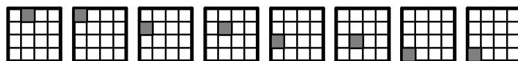
Figura 3: provini della seconda serie; il rapporto tra il lato del campione ed il difetto è quattro.
