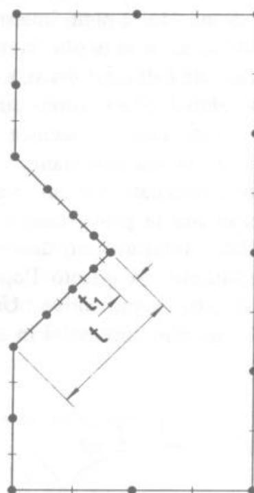
Figura 5 - Discretizzazione di base utilizzata per l'analisi con elementi di contorno.
