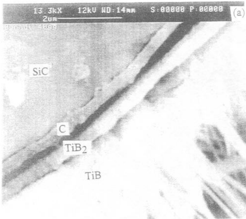
Fig.3 - Composito dopo 1000 ore a 600 °C (a); analisi EDS dello strato di reazione (b).
