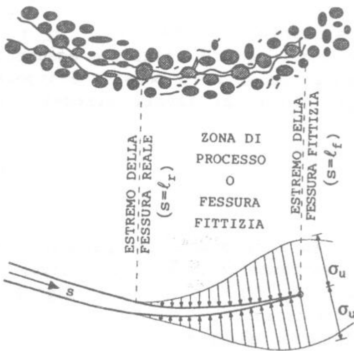
Fig. 1: Il modello coesivo rappresenta la zona di processo come un'estensione fittizia della fessura reale.
